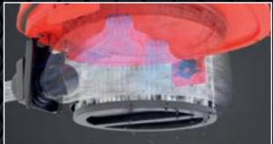
Er besteht aus zwei voneinander unabhängigen Filterkammern, die nacheinander abgereinigt werden. Saugstrom und Saugleistung bleiben dadurch auch während der Abreinigung auf konstant hohem Niveau, was eine permanente Absaugung garantiert.
